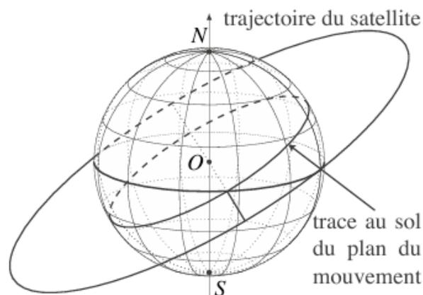
Le plan de l'orbite doit donc nécessairement être confondu avec le plan équatorial.
